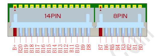
相关说明:采样排线的走线排布不要扯太紧,以免使用过程中拉扯松脱;主板插座和排线结合处要打胶固定。
